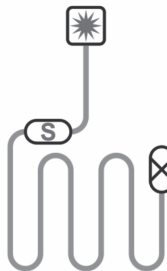
Схема укладки двожильного кабелю TXLP/2R
